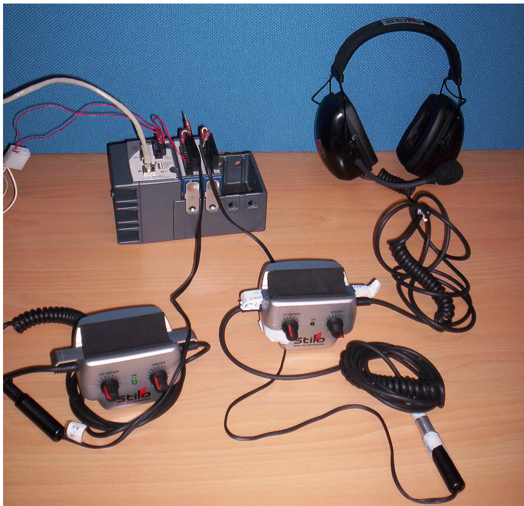
Figura 3.1: Apparato sperimentale prototipale: sono visibili le due centraline WRC03, il cRIO 9101 e un paio di cuffie
